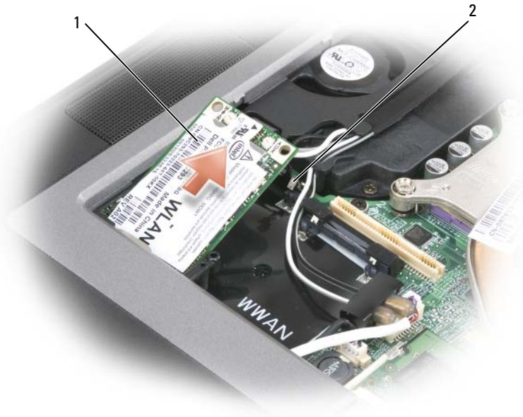
1 плата беспроводной локальной сети (WLAN) 2 металлические скобы (2)
